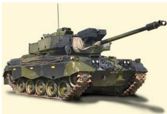
Versão final após o repotenciamento efetuado pelos Dinamarqueses nos seus M-41. (Fotos: Exército da Dinamarca)
