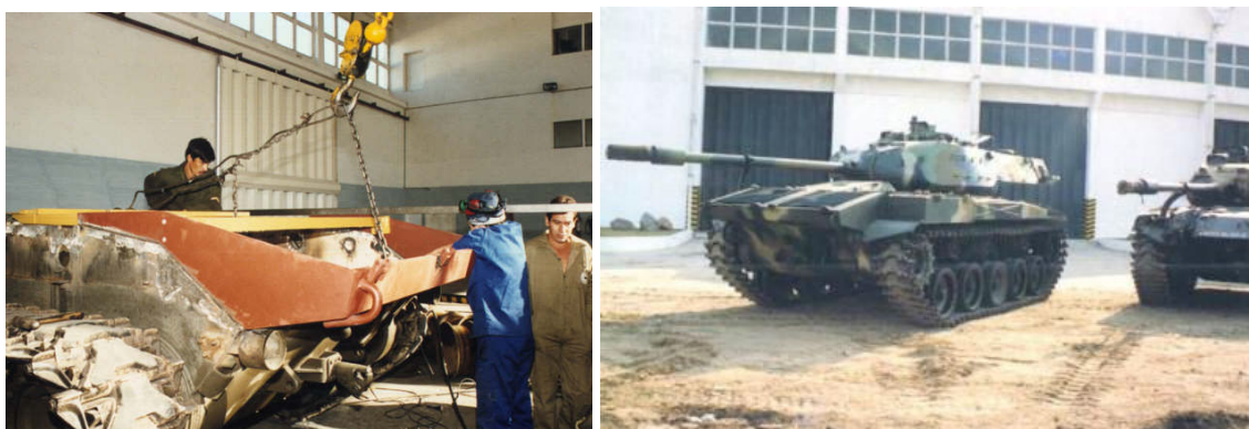
Início dos trabalhos de substituição do motor e a configuração final do M-41 A1UR. (Fotos: arquivo Cel. Raúl Urioste)
