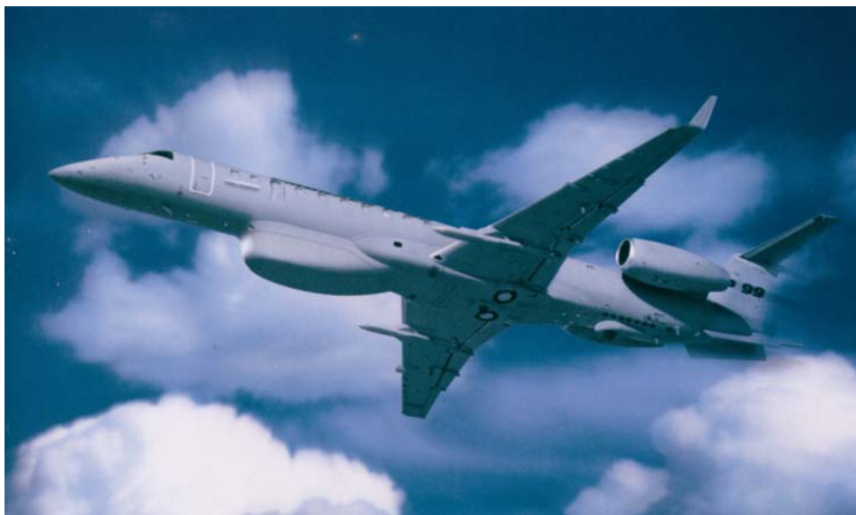
Concepção artística da versão de patrulha marítima do Embraer 145 denominada R-99. (Foto Embraer)
