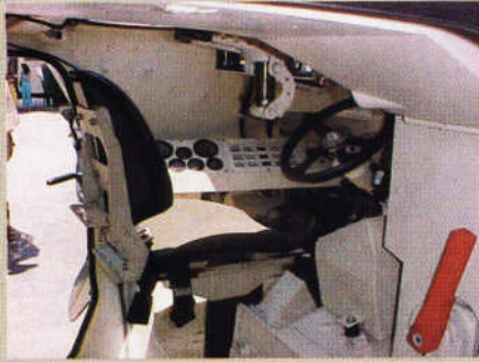
Compartimento do motorista. Os instrumentos ficam no lado esquerdo. Notar os três visores
