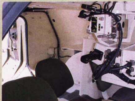
O interior do carro visto a partir da frente. Em destaque o visor de tiro noturno da metralhadora
