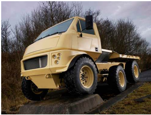
Vistas frontal e traseira do TMV 6x6M. Notar o formato em “V” do chassi e com o este protege toda a parte inferior do veículo que possui um conceito modular. (Fotos: TMV Ltd)
