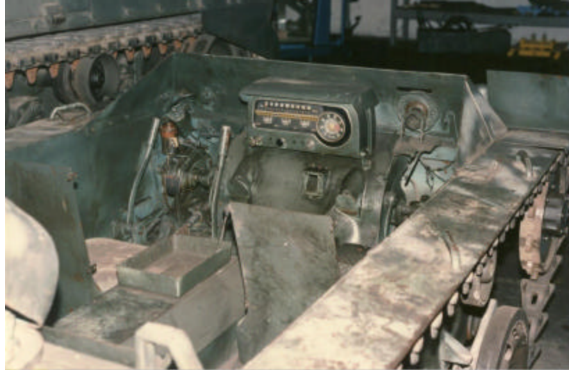
Detalhe do interior do CUTIA. Notar o painel do veículo JK, as alavancas de direção e à direita o olha para a metralhadora .30. (Coleção autor)
