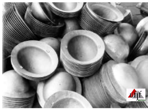
Foto 17 – Capacetes modelo Inglês MK-1 prontos faltando parte interna e pintura. Fábrica do Andaraí.
