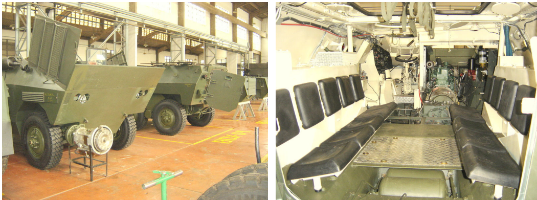
Dois dos seis novos EE-11 Urutu adquiridos pelo Exército em fase final de acabamento no AGSP em 09 de fevereiro de 2007. Eles eram originariamente, versão porta-morteiro, daí a razão para o repotenciamento. Notar o seu interior, agora na versão transporte de tropas. (Fotos: autor)
