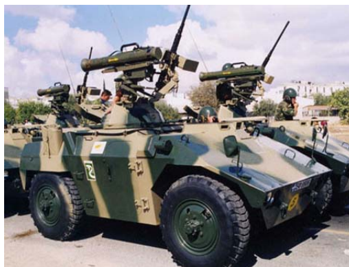
EE-3 Jararaca do Gabão, à esquerda, armado com metralhadora e do Chipre, à direita, com mísseis anticarro Milan e metralhadoras. (Fotos: Engesa)
