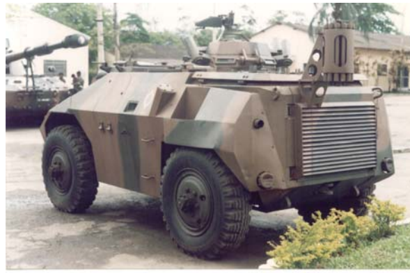
Protótipo do EE-3 Jararaca de Guerra Química. Notar o dispositivo que lança bandeirolas coloridas na parte traseira do veículo para marcar os tipos de substâncias existentes no campo de batalha. Apenas um construído. Esse exemplar se encontra em poder do Exército Brasileiro no 13º Regimento de Cavalaria Mecanizado em Pirassununga, SP. (Crédito das fotos: autor)
