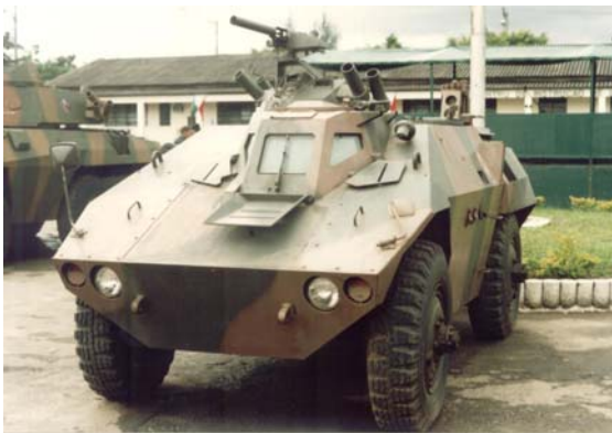
Protótipo do EE-3 Jararaca de Guerra Química. Notar o dispositivo que lança bandeirolas coloridas na parte traseira do veículo para marcar os tipos de substâncias existentes no campo de batalha. Apenas um construído. Esse exemplar se encontra em poder do Exército Brasileiro no 13º Regimento de Cavalaria Mecanizado em Pirassununga, SP. (Crédito das fotos: autor)
