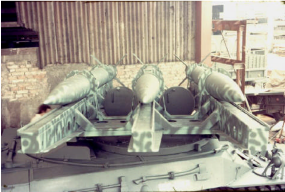
Detalhe frontal da rampa de lançamento com os foguetes X-40 em posição de transporte. (Crédito da foto: autor)
