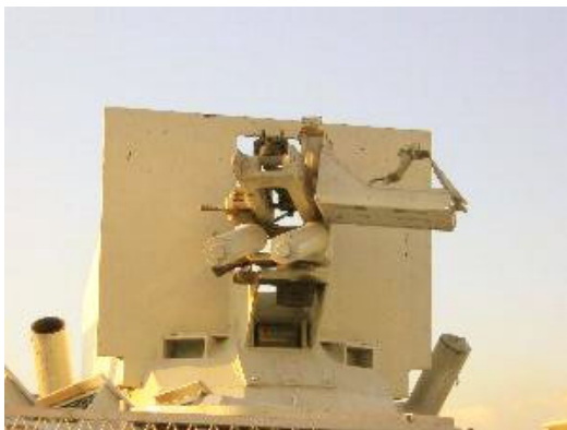
Proteção blindada fabricada pela empresa Haitiana La Perfection em detalhe lateral e frontal e já em uso nos EE-11 Urutu em patrullha urbana em Cite Soleil. (Fotos: arquivo Cap. Lyzandro)
