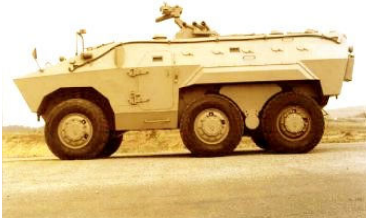
EE-11 Urutu na versão final de exportação. Notar os cubos de rodas com os redutores planetários, que o tornou mais macio com um maior conforto para a tripulação. (Foto; Coleção autor)
