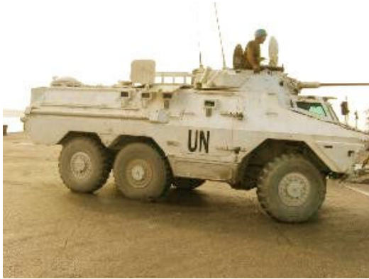
Blindado 6x6 RATEL do Exército da Jordânia em operação no Haiti. Notar a cabine blindada do motorista e no detalhe o tiro que poderia ter sido fatal para o motorista, mas que não ultrapassou o vidro blindado. (Fotos: Arquivo Cap. Lyzandro)
