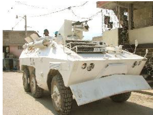
Urutu versão transporte de tropas “moustache” (bigode) removendo obstáculo e detalhe da lâmina acoplada ao veículo no AGSP pela Centigon e proteção blindada na torreta feita no Haiti. (Fotos: Arquivo Cap. Lyzandro)
