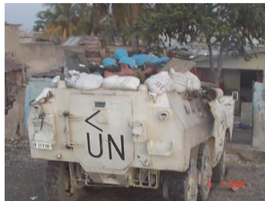
Diversos EE-11 Urutu em operação com as tropas de paz do Exército Brasileiro no Haiti. Notar sacos de areias como forma de proteção para os tripulantes quando das escotilhas abertas na parte traseira. (Fotos: CComSEX)
