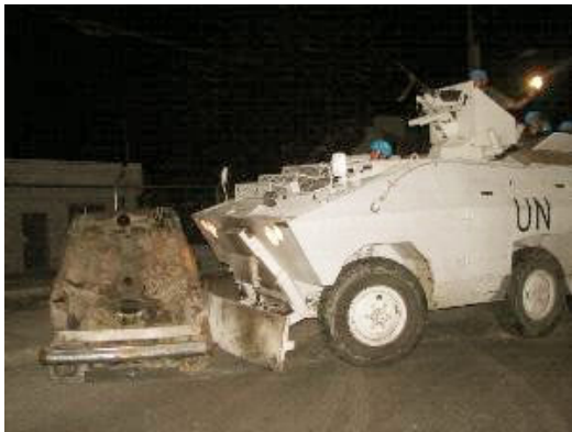
Urutu versão transporte de tropas “moustache” (bigode) removendo obstáculo e detalhe da lâmina acoplada ao veículo no AGSP pela Centigon e proteção blindada na torreta feita no Haiti. (Fotos: Arquivo Cap. Lyzandro)
