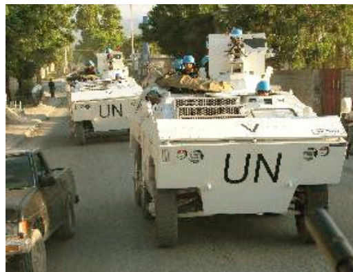
Proteção blindada fabricada pela empresa Haitiana La Perfection em detalhe lateral e frontal e já em uso nos EE-11 Urutu em patrullha urbana em Cite Soleil. (Fotos: arquivo Cap. Lyzandro)
