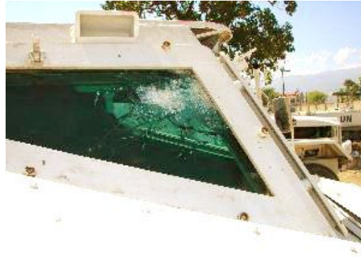
Blindado 6x6 RATEL do Exército da Jordânia em operação no Haiti. Notar a cabine blindada do motorista e no detalhe o tiro que poderia ter sido fatal para o motorista, mas que não ultrapassou o vidro blindado. (Fotos: Arquivo Cap. Lyzandro)
