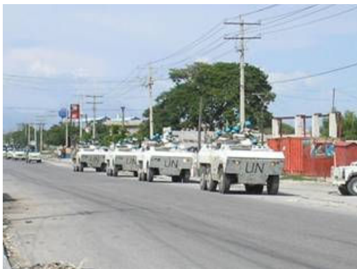
Diversos EE-11 Urutu em operação com as tropas de paz do Exército Brasileiro no Haiti. Notar sacos de areias como forma de proteção para os tripulantes quando das escotilhas abertas na parte traseira. (Fotos: CComSEX)
