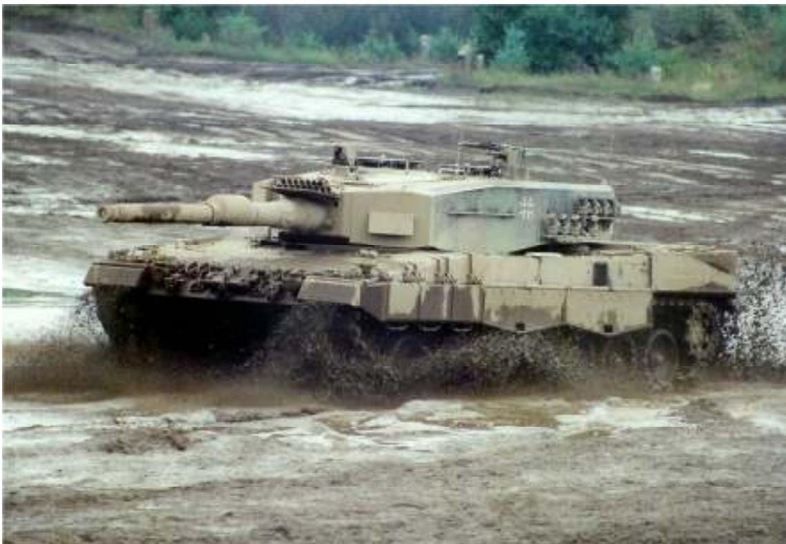
Leopard 2 A4 com canhão de 120 mm L44 com alcance útil de 5500m, motor MTU V12 de 1500 cv e velocidade máxima de 72km/h ( Crédito da foto: [http://www.primeportal.net/apc/tanks\\_mud.htm](http://www.primeportal.net/apc/tanks_mud.htm) )
