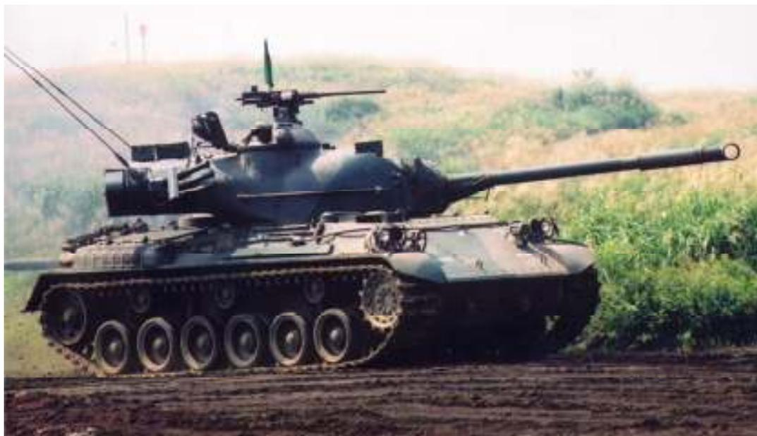
**Tipo 61 de fabricação japonesa - canhão de 90 mm, motor de 570 CV e blindagem máxima de 114 mm (Crédito da foto: [www.tankguy.gooside.com](http://www.tankguy.gooside.com))**
