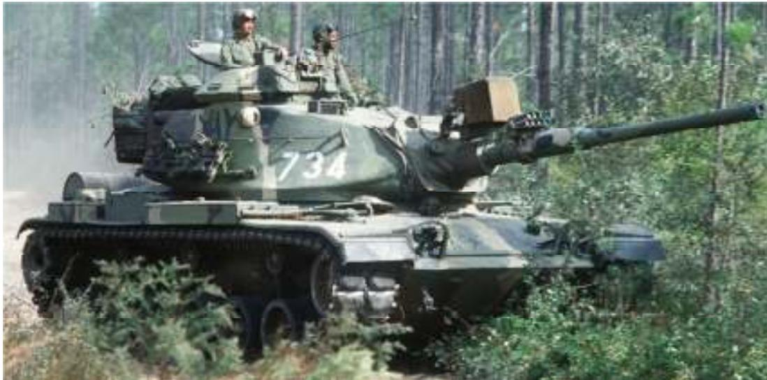
**M60 A1, blindado de segunda geração com inúmeros artifícios eletrônicos como a estabilização d'armas para observação (não para tiro) e auxílio de um computador analógico para correção de tiro. (Crédito da foto: <http://afvdb.50megs.com/usa/pics/m60.html>)**
