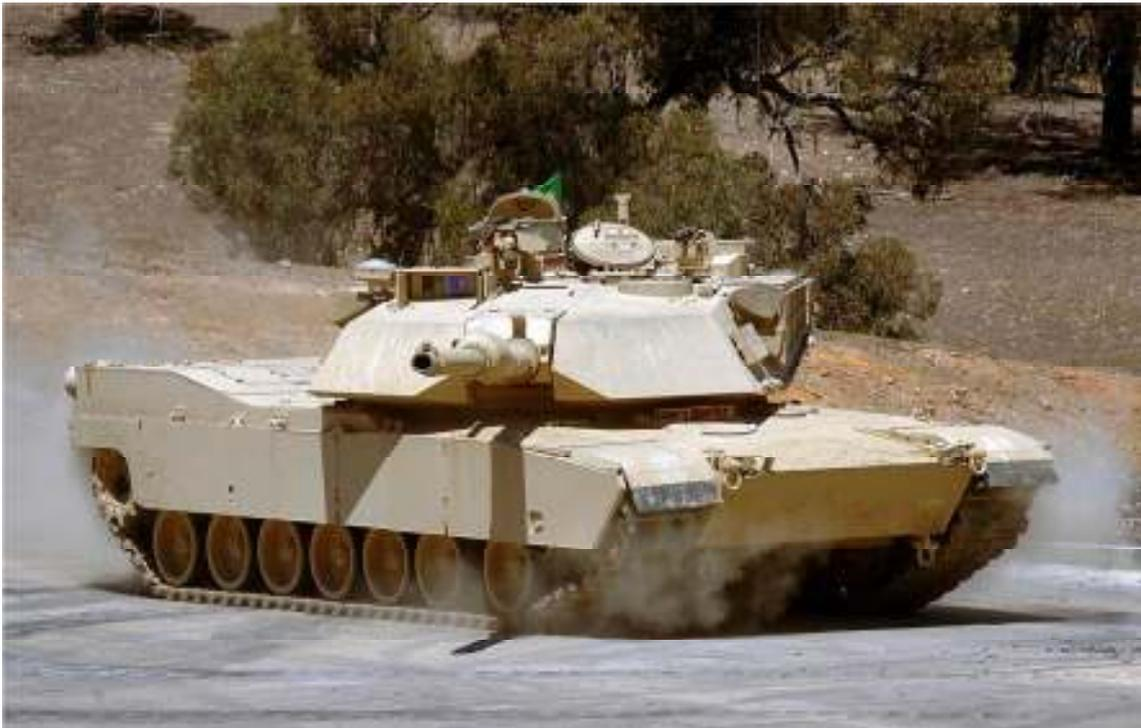
M1 A1 Abrams, o principal MBT de Terceira geração do Exército Americano com canhão de 120 mm com alcance eficaz de 5500m. Seu propulsor consiste de uma turbina a gás multicarburente que desenvolve 1500 cv e o impulsiona a 68 km/h. Possui as variantes M1 A2 e M1 A2 SEP que são da Geração Intermediária da Terceira Geração. (Crédito da foto: <http://www.armyrecognition.com/forum/viewtopic.php?t=1199>)
