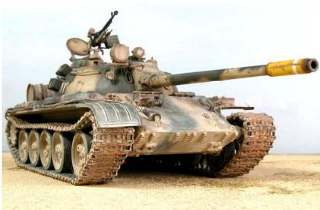
**T-55 russo, utilizado na América do Sul pelo Uruguai e Peru, possui canhão de 100 mm, blindagem máxima próxima de 200 mm, motor de 581 CV (Crédito da foto: [http://hsfeatures.com/t55cw\\_1.htm](http://hsfeatures.com/t55cw_1.htm) )**
