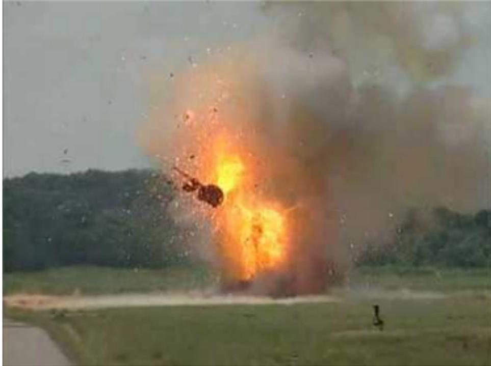
**Imagens demonstrativas do que acontece com um CC de Segunda Geração e inferiores quando qualquer armamento anticarro adentra o compartimento da tripulação, onde também está toda a munição. Reparem o que a explosão da munição empaiolada dentro da torre a faz(junto com sua tripulação) ser ejetada a vários metros do chassi**
