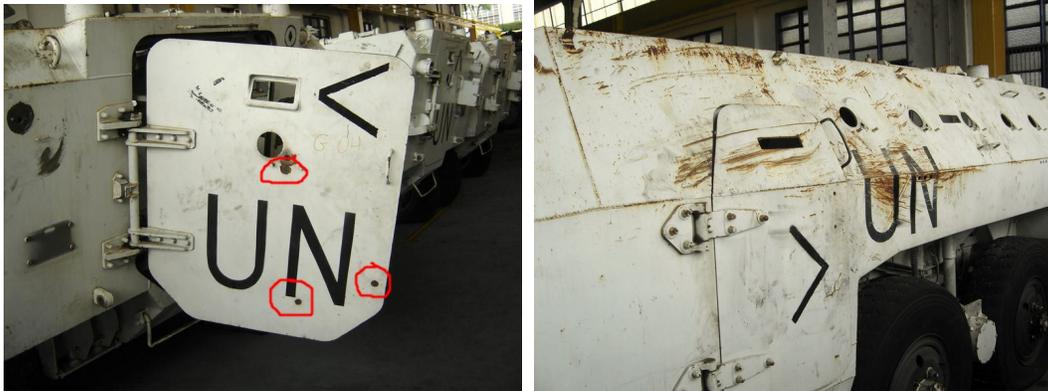
**Detalhes em vermelho de marcas de tiros na porta traseira de um EE-11 Urutu e lateral de um outro muito desgastado pelo uso excessivo no Haiti, quando avançam sobre barricadas feitas com restos de veículos e outros objetos. (Fotos: autor)**
