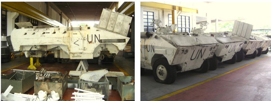
**O estado em que chegam os EE-11 Urutu's vindos do Haiti e sendo desmontados para uma nova reforma e posterior reenvio. (Fotos: autor)**
