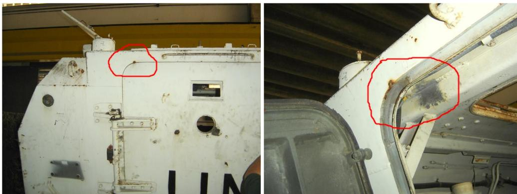
**Detalhe assinalado em vermelho por onde entrou o tiro de 7,62mm perfurante, na junção da porta com a carcaça do veículo, que ao resvalar na parte interna feriu um soldado brasileiro na perna. (Fotos: autor)**
