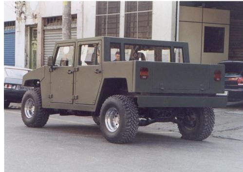
O Commando M-4 4x4 construído sobre o chassi completo de uma Pajero Full 2003 turbo diesel. (Fotos: coleção autor)
