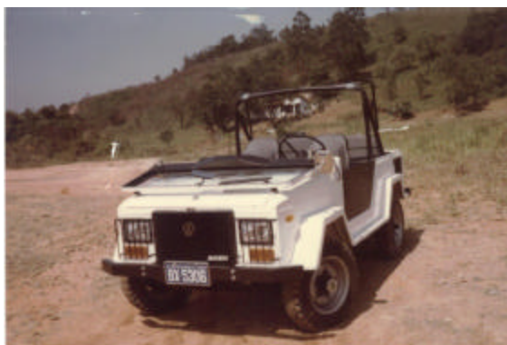
Primeiro projeto de um Jeep ENGESA 4x4 com motor diesel da Kombi. ( Fotos: Coleção autor – via George Avramidis)
