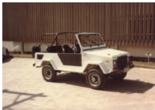
Primeiro projeto de um Jeep ENGESA 4x4 com motor diesel da Kombi. ( Fotos: Coleção autor – via George Avramidis)
