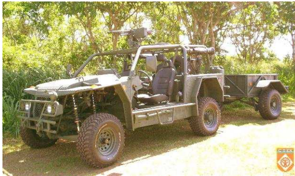
Vista frontal do Chivunk com metralhadora MAG 7,62mm, mísseis ALAC e seu reboque para cargas de 500kg, e detalhe da construção dos dois protótipos no AGSP, em julho de 2007. (Fotos: CTEx e autor)
