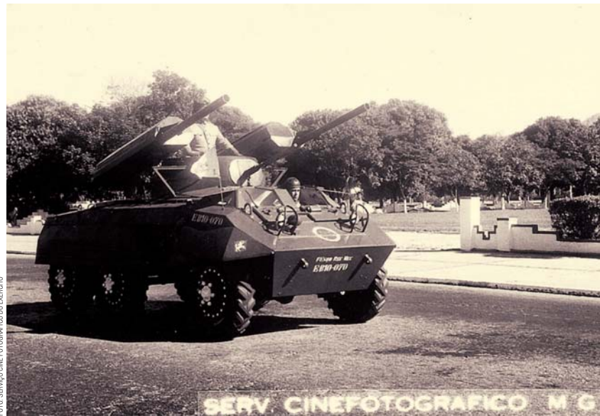
Acima, M-8 versão lançador de foguetes rotativo desenvolvido pelo IME nos anos 1960.
