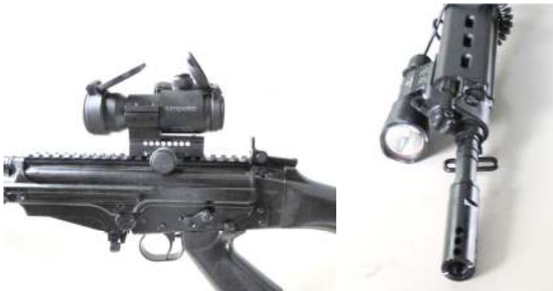
Detalhes da adaptação da luneta e da lanterna no FAL M964 A1/Pelopes. (Fotos: autor)
