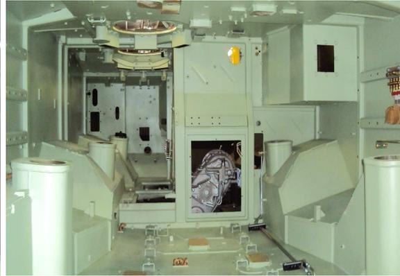
A carcaça com os batoques de blindagem adicional já totalmente pintada em verde (setembro de 2010) e detalhe do interior com o spall-liner colado e pintado em verde claro, em outubro de 2010. Notar a caixa de transferência já montada no seu compartimento.
