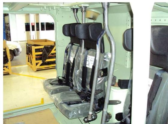
Montagem da estrutura dos bancos e com eles fixados no compartimento da tropa. (Fotos: DCT)
