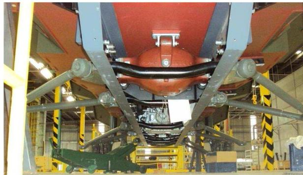
Detalhe do conjunto propulsor com a hélice de quatro pás e dos diferenciais montados sobre o veículo. Notar as longarinas do chassi, onde está fixada a suspensão, em novembro de 2010.
