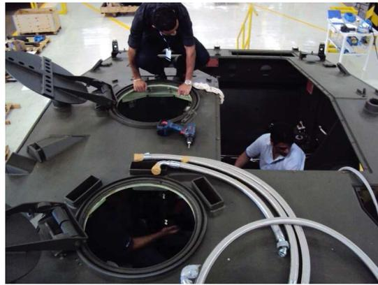
Montagem do motor e instalação do periscópio do motorista, em dezembro de 2010.
