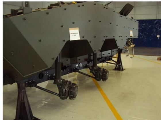
Montagem das duas longarinas do chassi e da suspensão do lado direito. Todo o conjunto de suspensão, com exceção dos diferenciais, está fixado nas longarinas, em outubro de 2010.
