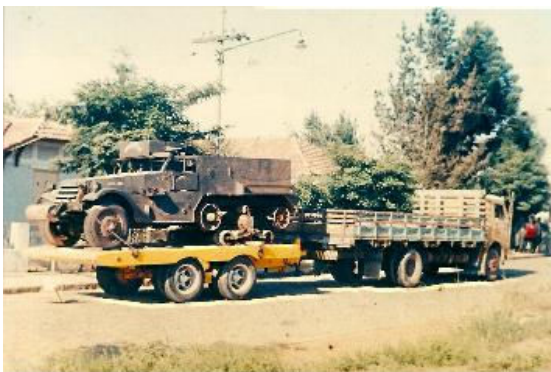
Meia-lagarta M-2 antes e depois do repotenciamento, onde recebeu motor diesel e lagartas recuperadas pela Novatração em março e junho de 1967. (Fotos: coleção autor)
