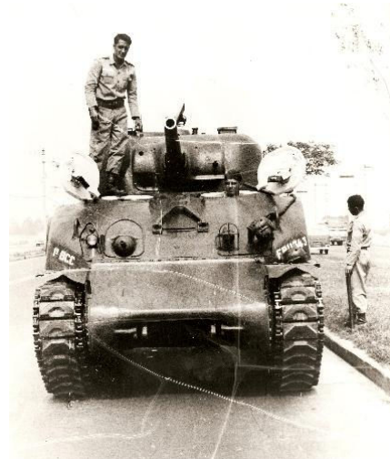
Três veículos com lagartas da Novatração no PqRMM/2 e teste de prova de lagartas Novatração no M-4 Sherman em 1966 no percurso Rio de Janeiro – Valença. (Fotos: coleção autor)
