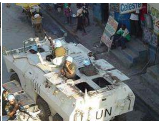
Urutu com o primeiro modelo de torreta para o atirador e um com a lâmina do tipo “bulldozer” para remoção de obstáculos e a vulnerabilidade inicial do veículo. (Fotos: Cap. Lyzandro e CComSex)
