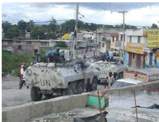
No início, motorista e atirador sem qualquer proteção, mas com sacos de areia na parte traseira e proteção da torreta do atirador feita localmente. (Fotos: CComSEX e Reuters)
