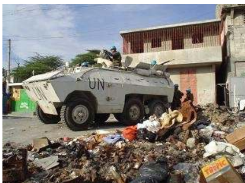
No início, motorista e atirador sem qualquer proteção, mas com sacos de areia na parte traseira e proteção da torreta do atirador feita localmente. (Fotos: CComSEX e Reuters)
