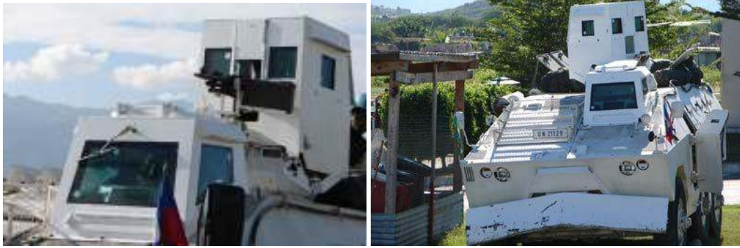
Detalhe da cúpula blindada do motorista, torreta do atirador e lâmina frontal. Três novos itens para operações em áreas urbanas. (Fotos: CComSEx)
