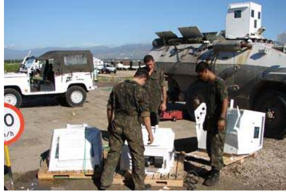
Detalhe da torreta blindada e montagem dos kits nos EE-11 Urutu no Haiti. (Fotos: AGSP e CComSEx)
