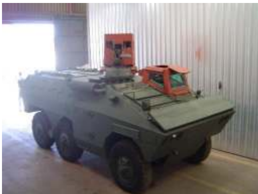
EE-Urutu com o kit de proteção. Detalhe da cúpula blindada para o motorista. (Fotos: AGSP)
