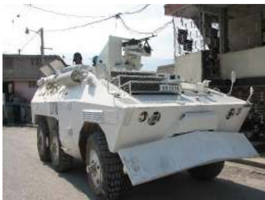
Urutu com o primeiro modelo de torreta para o atirador e um com a lâmina do tipo “bulldozer” para remoção de obstáculos e a vulnerabilidade inicial do veículo. (Fotos: Cap. Lyzandro e CComSex)
