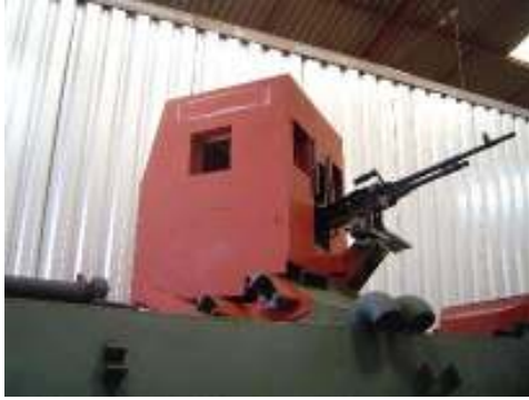
Detalhe da torreta blindada e montagem dos kits nos EE-11 Urutu no Haiti. (Fotos: AGSP e CComSEx)
