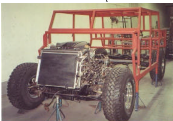
Estrutura tubular da versão civil "militarizada" sobre o chassi da Pajero Full 2003
