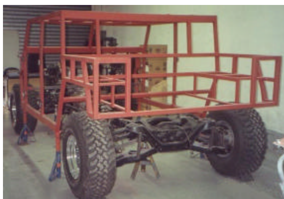
Estrutura tubular da versão civil "militarizada" sobre o chassi da Pajero Full 2003
