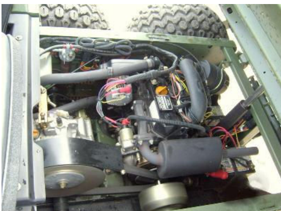
Detalhe do motor que fica em baixo da caçamba de carga. (Fotos: coleção autor)
