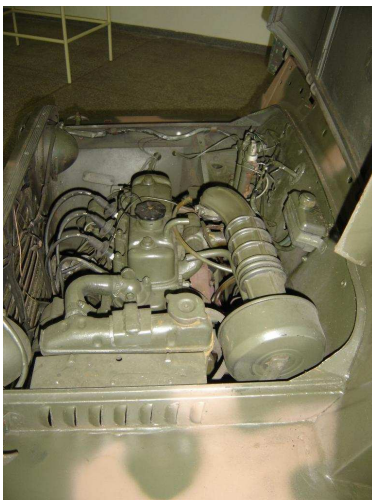
Detalhe do motor transversal BMC, 848 cc, 35 hp, a gasolina e da placa entalhada em madeira que explica as origens do veículo preservado no Museu do CIGS. (Fotos: autor)
