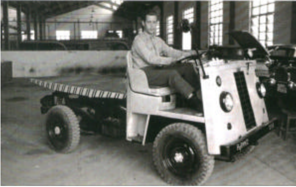
Mula mecânica construída no PqRMM/2 de São Paulo para transporte de material, usada apenas no interior da unidade. Crédito da foto: Coleção autor
