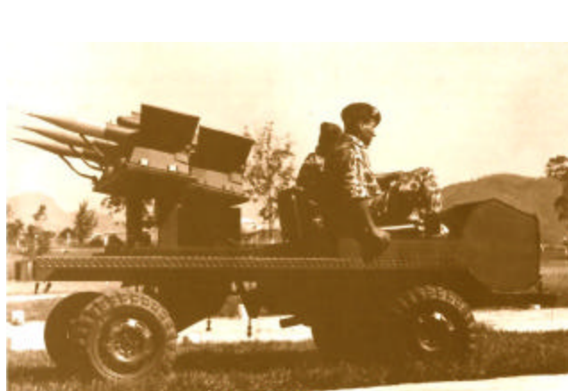
SAFO I versão metralhadora 7,62mm e porta mísseis Cobra SS-11 anti-tanque. Crédito das fotos: JAMY
