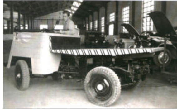
Mula mecânica construída no PqRMM/2 de São Paulo para transporte de material, usada apenas no interior da unidade. Crédito da foto: Coleção autor
