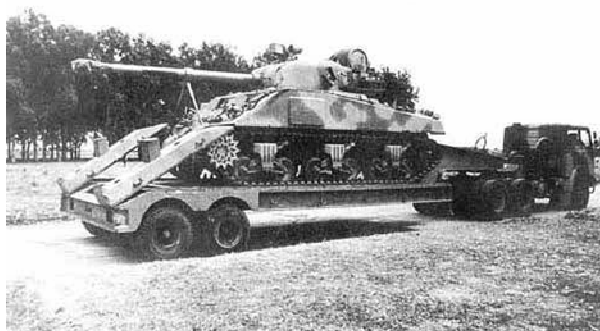
"Sherman Repotenciado". Fueron modernizados en Argentina con un cañón francés de 105 mm, dirección de tiro y motor Poteau de 520 hp. Aunque los "Sherman" debían ser sustituidos por los TAM, la crisis con Chile obligó a modernizarlos, entre 1977 y 1978, para mantenerlos operativos. (Foto: Vía Jed Military Equipment)
