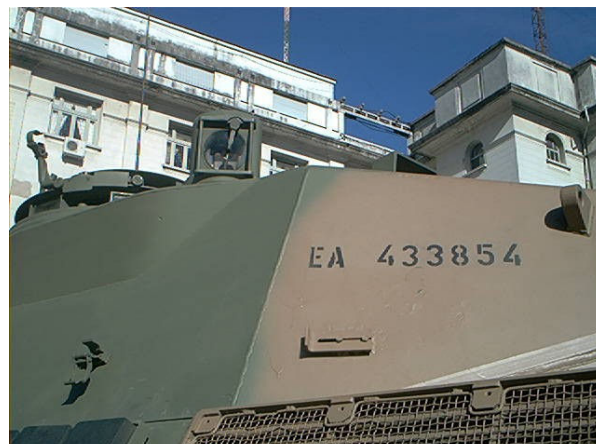
El PERI R/TA es parte fundamental del sistema de dirección de tiro del TAM. (Foto: Marcelo Rivera - Dintel GID)
