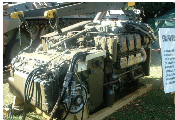
Motor MB-833 Ka500 expuesto en la Expo Palermo 2005 simulando el procedimiento de montaje. Este poderoso motor diesel entrega 720HP a 2.400 rpm. (Foto: Marcelo Rivera - Dintel GID)
