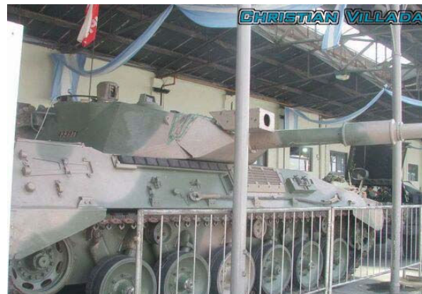
El prototipo del programa TAM S21 durante uno de los SIMPRODE. Dotado de cámara térmica, esta modificación le permite a la tripulación batir blancos de día y de noche en cualquier condición de visibilidad, incluyendo humo o niebla. (Foto: Christian Villada - SAORBATS)
