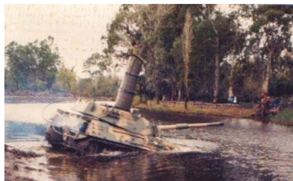
Un TAM inicia el procedimiento de vadeo profundo, nótese el Jefe de Tanque sobre el snorkel, comandando la operación y dando instrucciones al conductor. Así preparado es capaz de moverse en cauces de agua de hasta 4 metros de profundidad. (Foto: Archivos Dintel GID)
