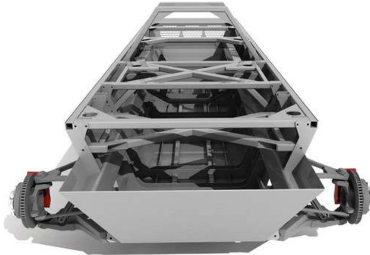
Chassi em aço inoxidável que abrigará as partes vitais do novo veículo TVM 6x6M. Notar os freios a disco ventilados de 300mm. (Fotos: TMV Ltd)
