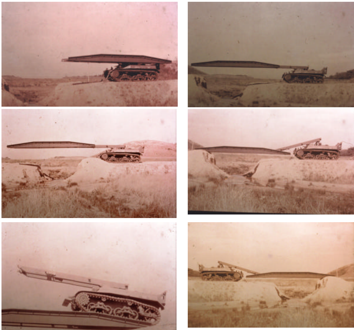
Seqüência mostrando o sistema de colocação e remoção da ponte do XLP-10. (Coleção autor)
