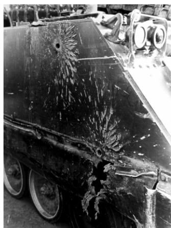
Viaturas M-113 e LVTP-7 destruídas por disparo de foguete e I.E.D. no Iraque
