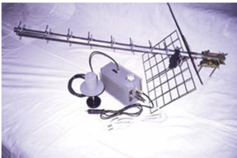
Figura 6 – Empastelador portátil de GPS de fabrico russo.
