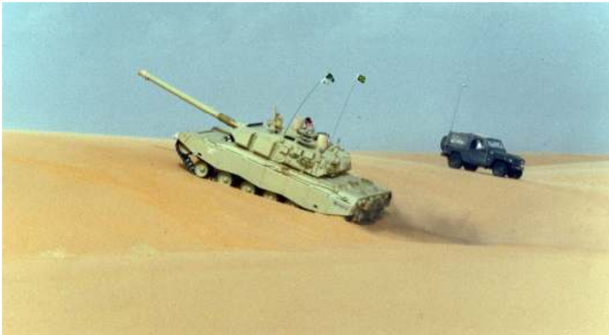
Protótipo P2 do EE-T1 Osório realizando testes na região de Sharourah, na Arábia Saudita, em 1987, com canhão GIAT 120 mm, onde participou de uma concorrência ao lado dos carros de combate M-1 Abrams (USA), AMX-40 (França) e Challenger (Inglês), surpreendendo. (Crédito da foto: Coleção Autor)
