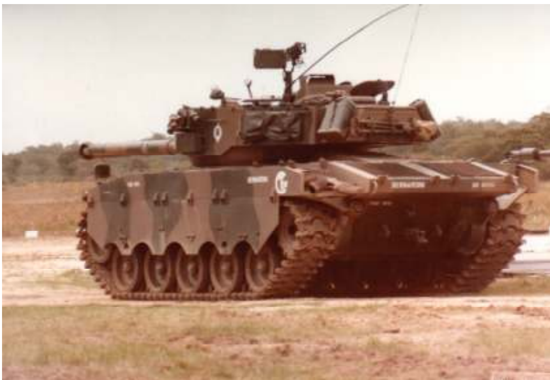
Versão final do que deveria ter sido o M-41C modernizado pela Bernardini. Notar as saias laterais e canhão francês Super 90 capaz de disparar a munição cônica dummy 90 mm F4 que nunca foram aplicadas aos veículos de série, em outubro de 1985. Este canhão foi usado num dos protótipos do MB-3 Tamoyo I. (Crédito da foto: Arquivo Flávio Bernardini)
