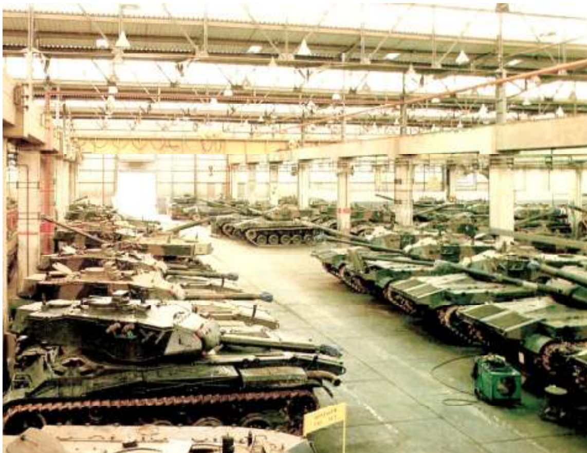
Linha de modernização do M-41 e M-41A3 para a versão nacional M-41C na Bernardini S/A Indústria e Comércio, em São Paulo, SP. (Crédito da foto: Coleção Autor).
