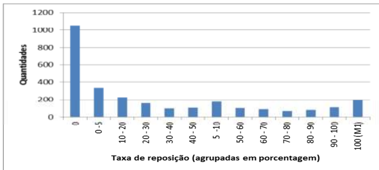
Figura 7 - Distribuição de peças por mortalidade. A revitalização possui duas características que a tornam um problema mais complexo do que a montagem de um veículo. Primeiro, trata-se de um processo que envolve a desmontagem, manutenção e montagem de uma viatura. Segundo, como se observa neste gráfico, as peças possuem mortalidades diferentes, o que dificulta a previsão de quantidades. Essa incerteza na gestão do material resultava em atrasos provocados por falta de algumas peças e excesso em outras. Fonte: Barbosa, 2015.
