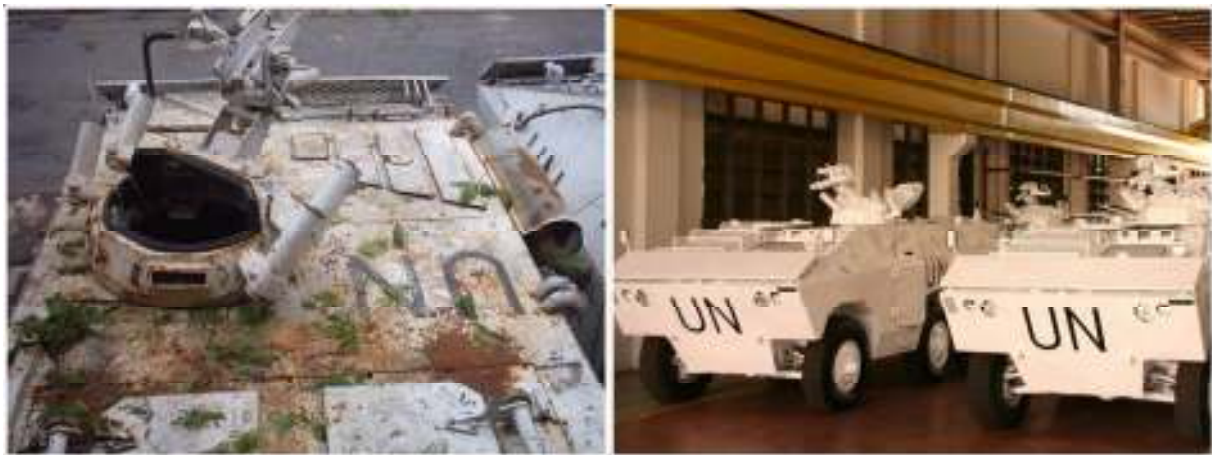
Figura 11- As viaturas chegavam do Haiti bastante deterioradas, apresentando desgaste da pintura e corrosão acentuada. O Arsenal também registrou a chegada de uma viatura com a caixa de mudanças travada. Houve também viaturas com problemas sérios na carroceria, como abalroamento e perfurações por tiro. Fonte: arquivo de fotos do AGSP, 2006.
