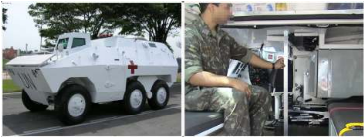
Figura 12 – À esquerda, fotografia da ambulância preparada em aproximadamente dois meses. O fato de haver viaturas recém revitalizadas facilitou muito essa preparação. Na época, havia uma carcaça de ambulância, da qual foi removido o sobreteto para aplicação. Na direita, engenheiro do AGSP mostra o espaço interno da viatura. Fonte: arquivo de fotos do AGSP, 2005.
