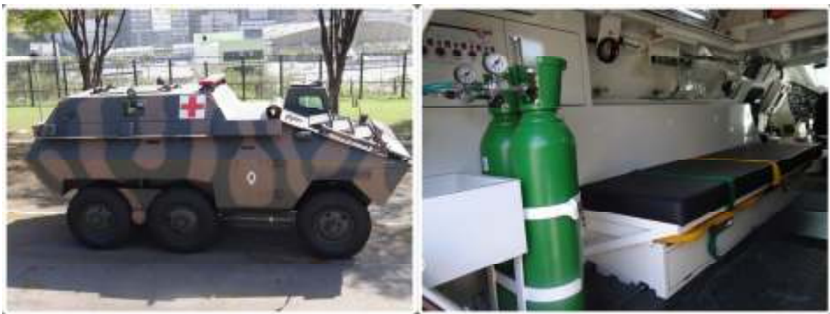
Figura 15 – Uma das quatro ambulâncias entregues pela Universal. O edital previa a transformação de Urutu dos modelos II e VII. Este último, montado a partir da carcaça que havia cedido o sobreteto da ambulância transformada em 2006. Fonte: arquivo de fotos do AGSP, 2012.
