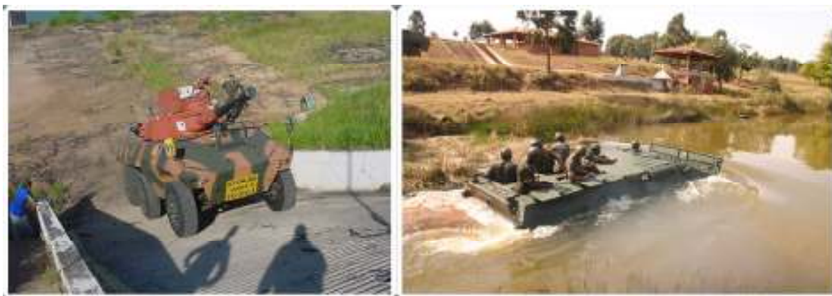
Figura 6 – Na esquerda, flagrante do primeiro teste do Cascavel na antiga pista da Motopeças. A pista era gentilmente cedida pela dona da área (Usiminas), possuindo rampa de 60%, rampa lateral, fosso e um imponente lago para realização das provas de navegabilidade do Urutu, como se vê à direita. Fonte: arquivo de fotos do AGSP, 2001 (esquerda) e arquivo de fotos do AGSP, 2006.
