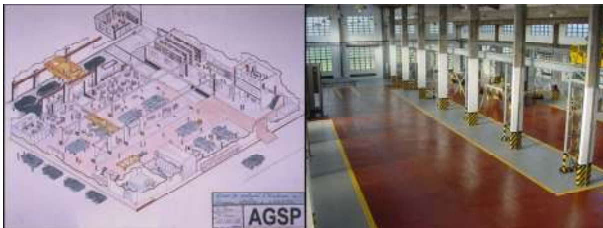
Figura 2 - Na esquerda, representação artística do conceito da Linha de Blindados. O desenho, feito pelo então Tenente Marcelo Franco de Sá Ribeiro, ilustrava uma dinâmica de linha de montagem, onde a carroceria seria movimentada através de células, recebendo em cada uma delas os componentes até se chegar no carro completo. Essa ideia foi abandonada e a montagem das viaturas passou a ser realizadas em boxes fixos. As carcaças também passaram a entrar nos boxes pintadas em verde, sendo que o carro só seria camuflado durante a preparação final para a expedição. Na direita, a linha de Blindados em 2000. Nota-se que estão posicionadas duas carcaças pintadas no padrão camuflado. Fonte: AGSP, 1999.
