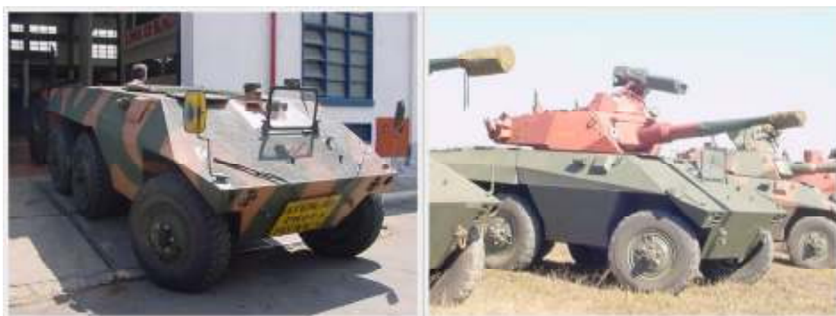
Figura 5 – Na esquerda, primeira avaliação técnica, realizada em março de 2001. Além da pintura camuflada do cabeça de série, é possível observar a viatura ainda sem a torre, com a finalidade de proporcionar melhor observação do funcionamento dos grandes conjuntos. Um mecânico da empresa contratada acompanhou o teste pela Rodovia Castelo Branco. Mais tarde, os testes sem a torre passaram a ser realizados apenas dentro do AGSP. Na direita, viaturas antes da execução do tiro técnico na AMAN em julho de 2001. O Cascavel camuflado foi um dos carros solenemente entregues ao 11º Esq C Mec em 21 de maio de 2001 (o teste do canhão foi realizado após a entrega). Os carros normalmente tinham a carroceria pintada em verde e a torre em vermelho, com o objetivo de caracterizá-los como carros em processo de revitalização. Fonte: arquivo de fotos do AGSP, 2001.
