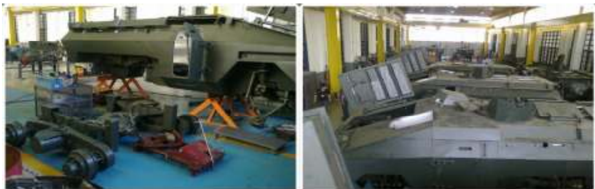
Figura 14 - A manutenção modificadora expandiu a capacidade de produção, criando nova linha de montagem onde ficava uma oficina de desmontagem dos carros. Foi um grande desafio tanto pelo novo modelo de trabalho como pela implantação de modificações em projeto. Fonte: arquivo de fotos do AGSP, 2012.
