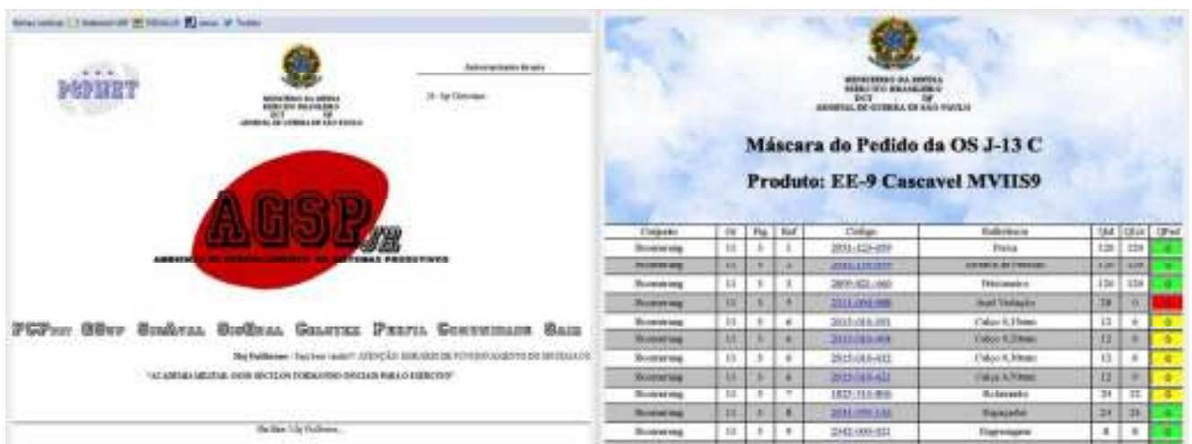
Figura 8 – Na esquerda, tela do AGSPjr. Na direita, máscara de pedidos do sistema. O uso de banco de dados para controle da produção e gestão de suprimentos facilitou o gerenciamento do Projeto Fênix, permitindo melhor planejamento para aquisição de material e maior facilidade na identificação de possíveis problemas decorrentes de incertezas no pedido de peças. Outro benefício do AGSPjr foi que seus dados permitiram escrever o termo de referência da terceirização iniciada em 2012. O conhecimento mais preciso sobre a mortalidade de peças, tempos e programação foi fundamental para se chegar a um preço mais realista. Fonte: autor.
