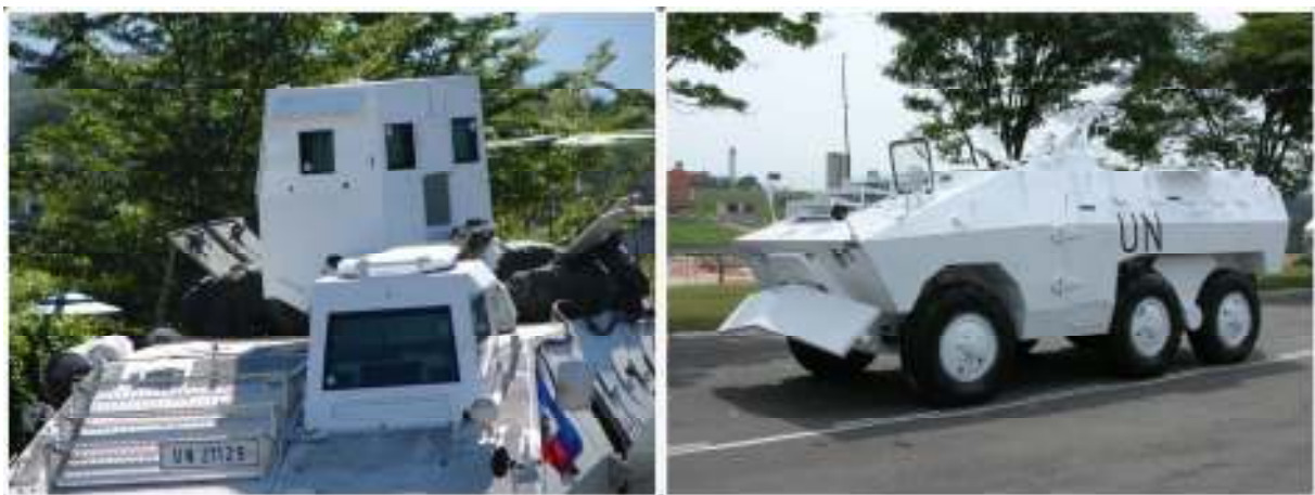
Figura 13 – O sucesso da ambulância incentivou o desenvolvimento de novos dispositivos para operação no Haiti. Na esquerda, a visão de uma viatura em solo Haitiano onde se vê a Proteção Balística do Motorista (PBM) e a Proteção Balística do Atirador (PBA). Na direita, o “Urutu Bigode”, veículo equipado com limpa-trilhos. Fonte: arquivo de fotos do AGSP, 2006.
