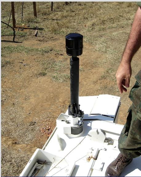
O sensor de laser que protege o veículo, identificando qualquer mira feita sobre o carro
