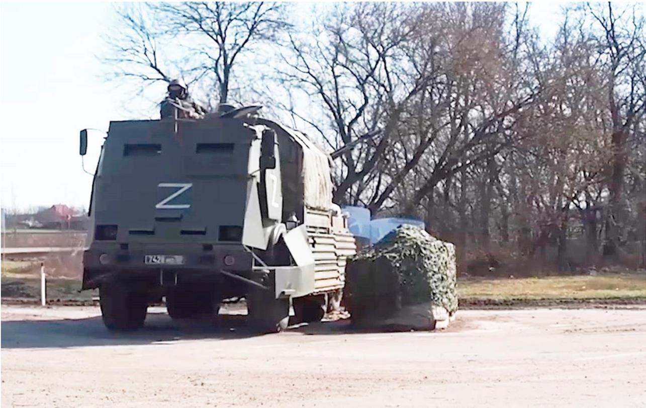
**Caminhão russo Kamaz equipado com um conjunto de metralhadora ZU-23-2 antiaérea calibre 23 mm com uma blindagem artesanal protegendo um *check-point*, realmente bem bizarro**
