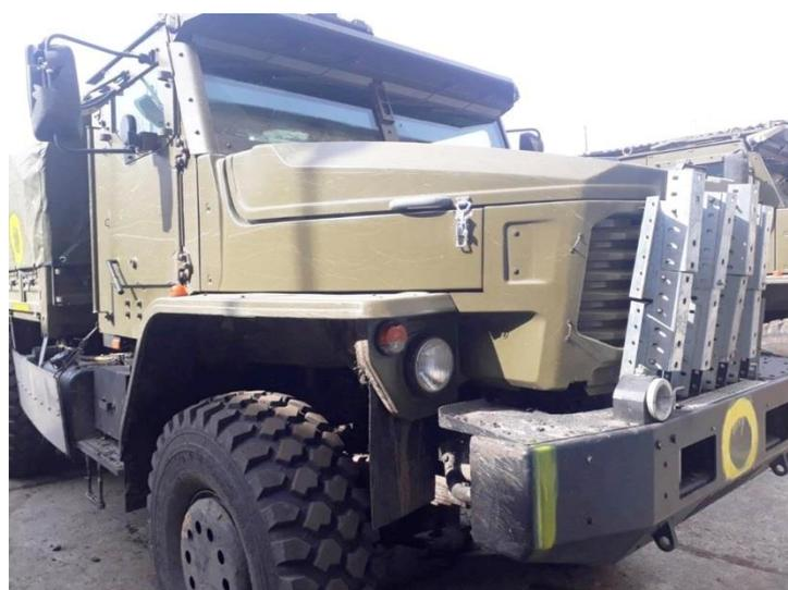
**Proteção muito diferente montada sobre um caminhão Ural com rodas de veículos civis e sacos provavelmente com areia. Ao lado um moderno caminhão Ural-6308 Tornado-U com uma proteção metálica na sua parte frontal**
