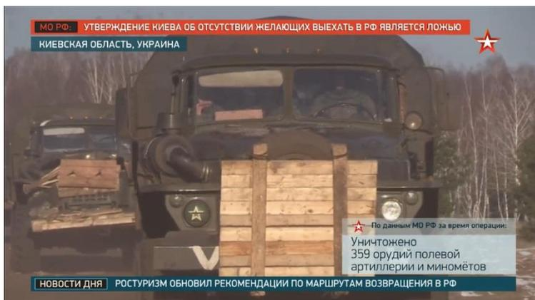
**Caminhões Ural com proteção improvisada em madeira nas suas partes frontais como forma de proteger radiador e motor**
