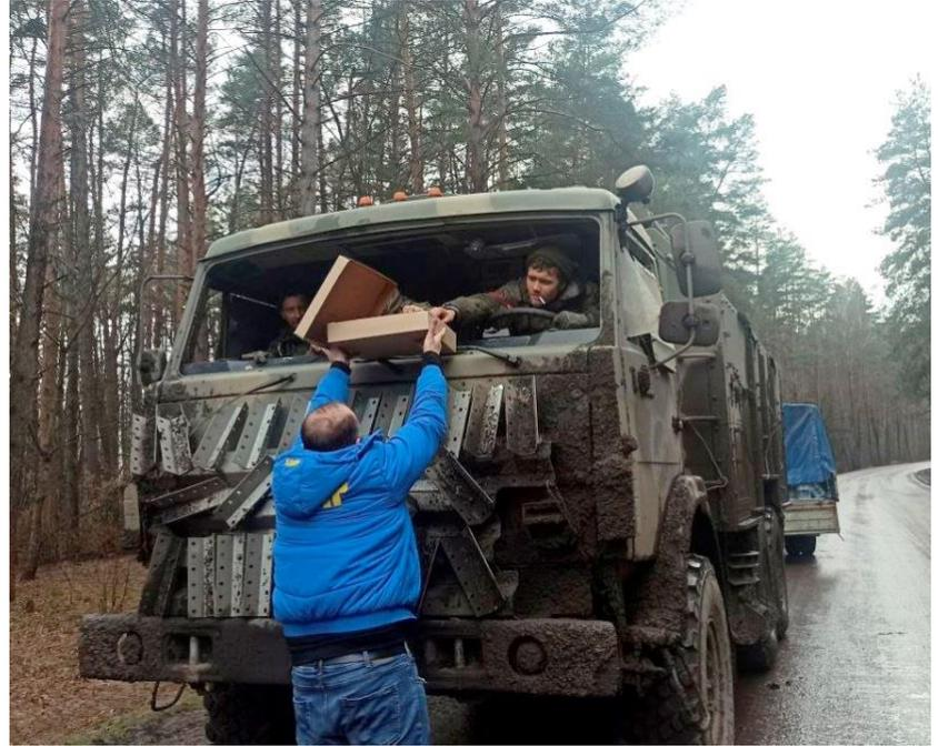
Outros tipos de proteção improvisada aplicada nas partes frontais e laterais de caminhões Kamaz como forma de aumentar a proteção da tripulação
