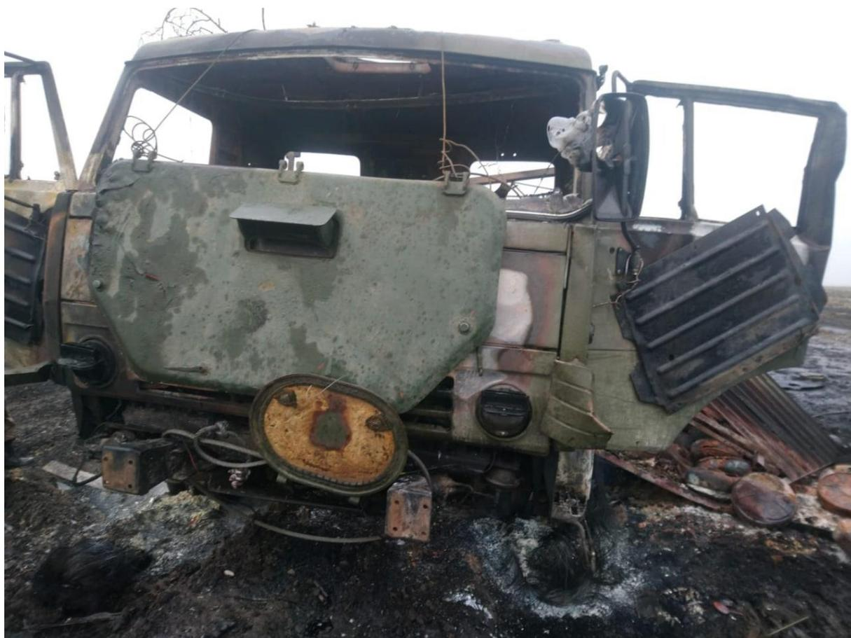
**Partes de um blindado sendo usado como proteção na parte frontal e laterais de um caminhão russo**
