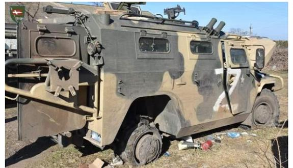
**GAZ Tigre capturado pelos Ucrânicos e sendo colocado para uso. Notar a perfuração na sua lateral próxima à roda traseira. No detalhe o dano causado em sua blindagem e outro danificado que será novamente usado após reparos. Notar que perdeu o pneu traseiro, um grande problema nos veículos russos sobre rodas neste conflito**
