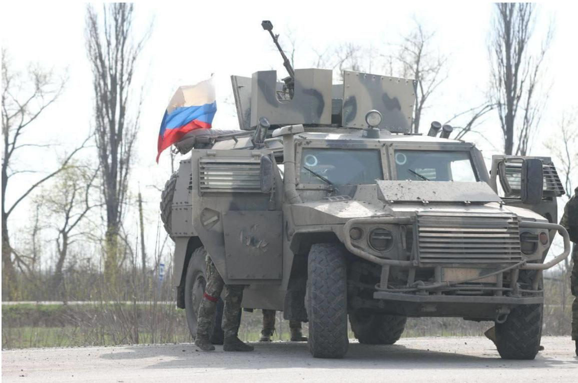
**GAZ Tigre com blindagem adicional frontal, lateral e vidros, e uma torre giratória com proteção para o atirador já sendo empregado na Ucrânia**
