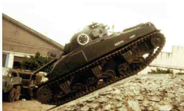
Teste de rampa do Sherman M-4 Composite Hull com o novo motor MWM V12 Diesel de 406 HP, cujos trabalhos se iniciaram em 1970 e ficaram parados por quatro anos
