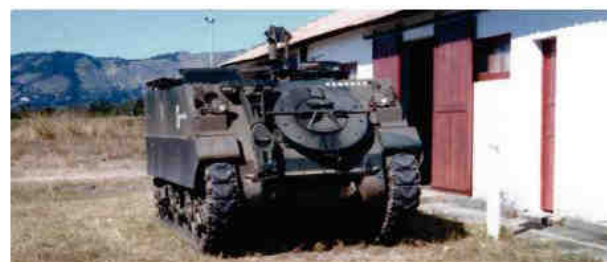
Protótipo do VBC Mrt 120mm XM3B1 sobre o chassi do Stuart M-3/M-3A1
