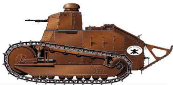
Modelo com torre fundida Berliet armado com canhão Puteaux
