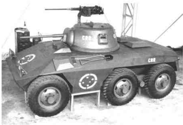
Mock-up na escala 1:1 Carro de Reconhecimento sobre Rodas, com a denominação CRR, no PqRMM/2, em São Paulo. Observe a torre da VBB com canhão de 37mm e metralhadora .50
