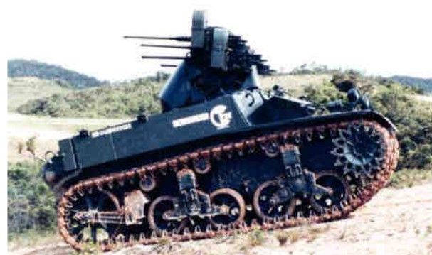
Protótipo do VBC AAe XM3D1 sobre o chassi do Stuart M-3/M-3A1
