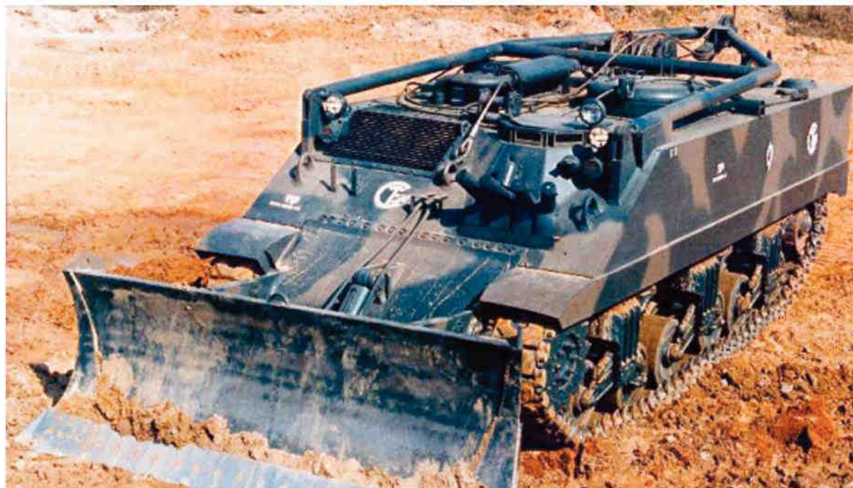
Carro Engenharia VBE-ENG-M4-30t Lag, construído a partir de um carro de combate Sherman M4, vendo sua lâmina frontal
