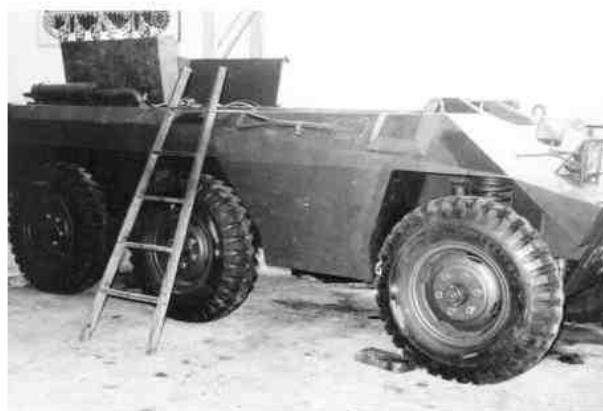
Finalização do chassi do protótipo do CRR no PqRMM/2, em São Paulo. Verificar que já estava com motor, suspensão e rodas, aguardando a torre que seria uma derivada do M-8
