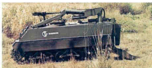
Protótipo do VBE Soc XM3C1 sobre o chassi do Stuart M-3/M-3A1
