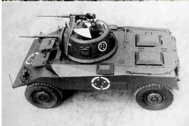
Segunda versão da Viatura Blindada Brasileira - VBB, nas três fotos acima. Notar que não possui mais o pneu estepe na lateral. Com o desenvolvimento do Pneu à Prova de Balas-PPB (Run flat) pela Novatracão houve um grande ganho operacional
