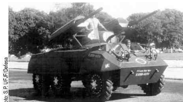
Lançador de Foguetes de 81mm, Suíço, montado sobre um blindado M-8, testado no Brasil
