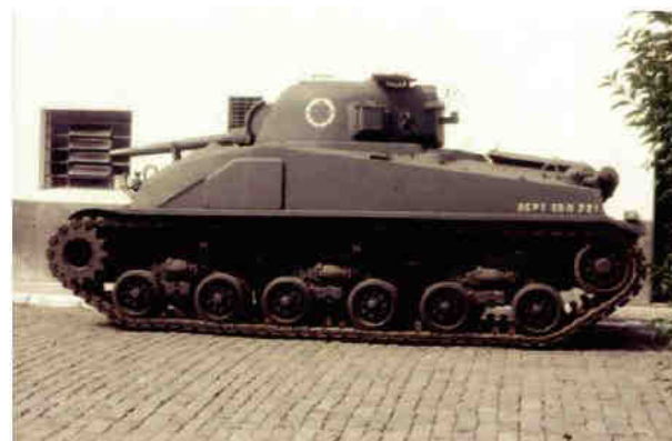
Sherman M-4 Composite Hull com a nova suspensão HVSS (Horizontal Volute Spring Suspension)
